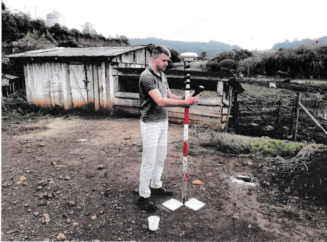
Foto1-Execução de levantamento topográfico com GNSS RTK (Rover) – Coleta de pontos de controle.
